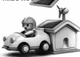
(左) 太陽光発電とモーターで動くソーラー充電カー (右) 光センサー・障害物よけ車
